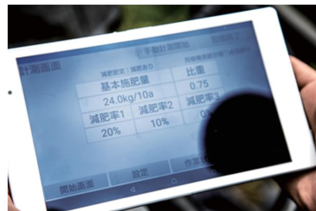
▲リアルタイムで土壌を検知し、施肥量を自動制御、圃場の稲の生育を平準化する
