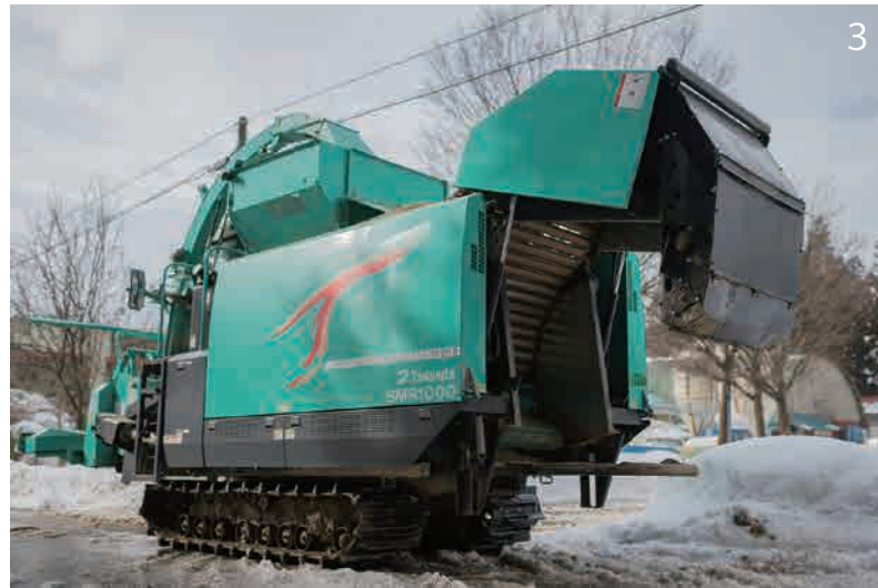
1. ホールクroppサイレージの山。雪がカラスの被害から守ってくれる。1 つ約 300kg。2. 搾乳した乳はタンクで 4℃まで冷やし、出荷される。3. 細断型ホールクropp収穫機で、稲を約 3 cmに細断し丸められる。できあがった粗飼料は食べやすいため、牛の食べ残しが激減した。
