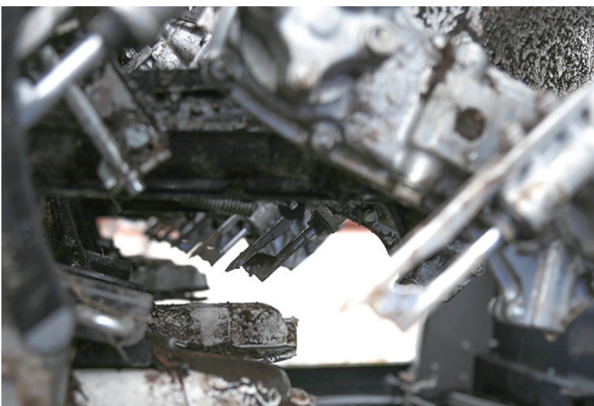
▲密苗専用の爪、標準より幅が狭い
