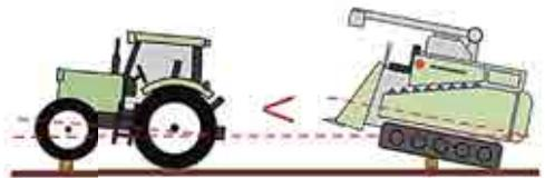
クローラー式のコンバインは車輪式のトラクターに比べ、小さな段差でも車体の傾きが大きい。
